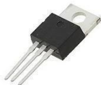
2.8- сурет – Lmx17hv тұрақтандырғышы
